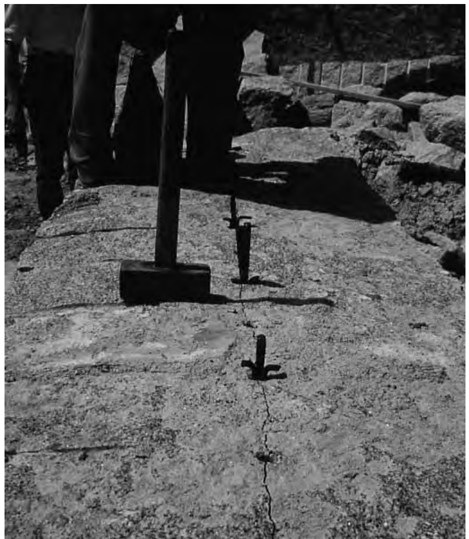
Granitgewinnung heute: mit Presslufthämmern werden Löcher vorgebohrt, in die Eisenkeile eingetrieben werden, bis der Granitblock reißt. Mit Kupferwerkzeugen ist es völlig unmöglich, Granit zu bearbeiten (Löhner)
